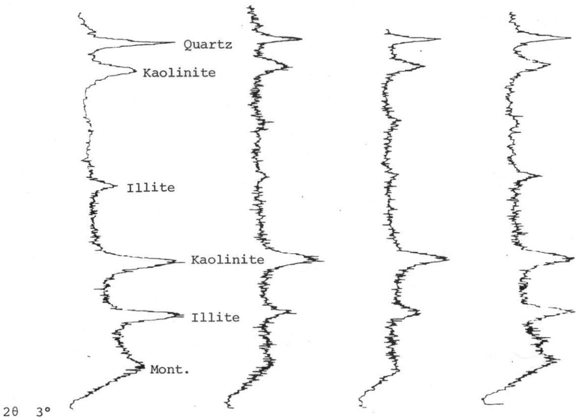
Figure 2. Diffractograms of (a) C5, (b) B92, (c) B92 - glycolated, (d) B50. Mont. = Montmorillonite.
