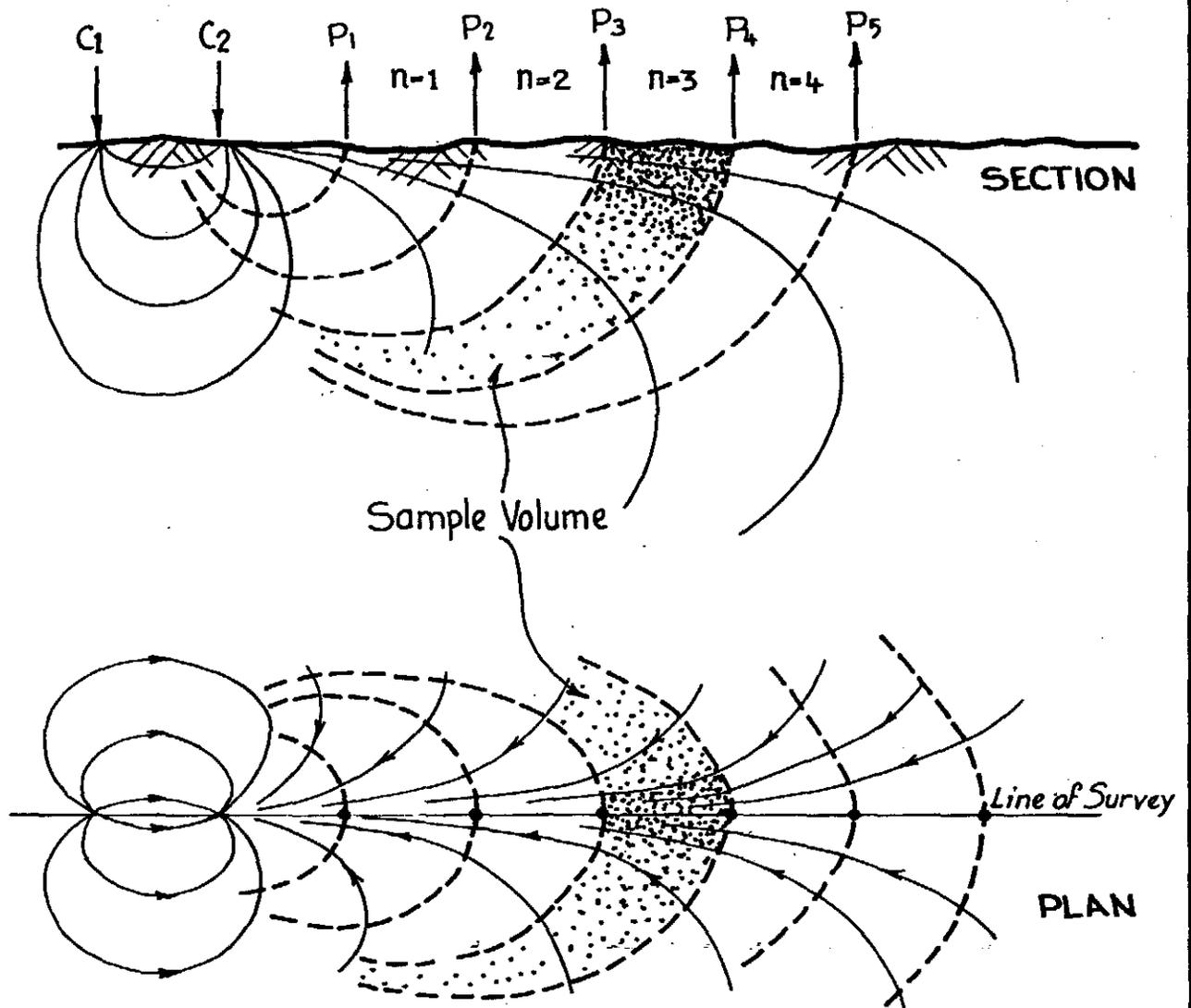
Dipole - Dipole Array
